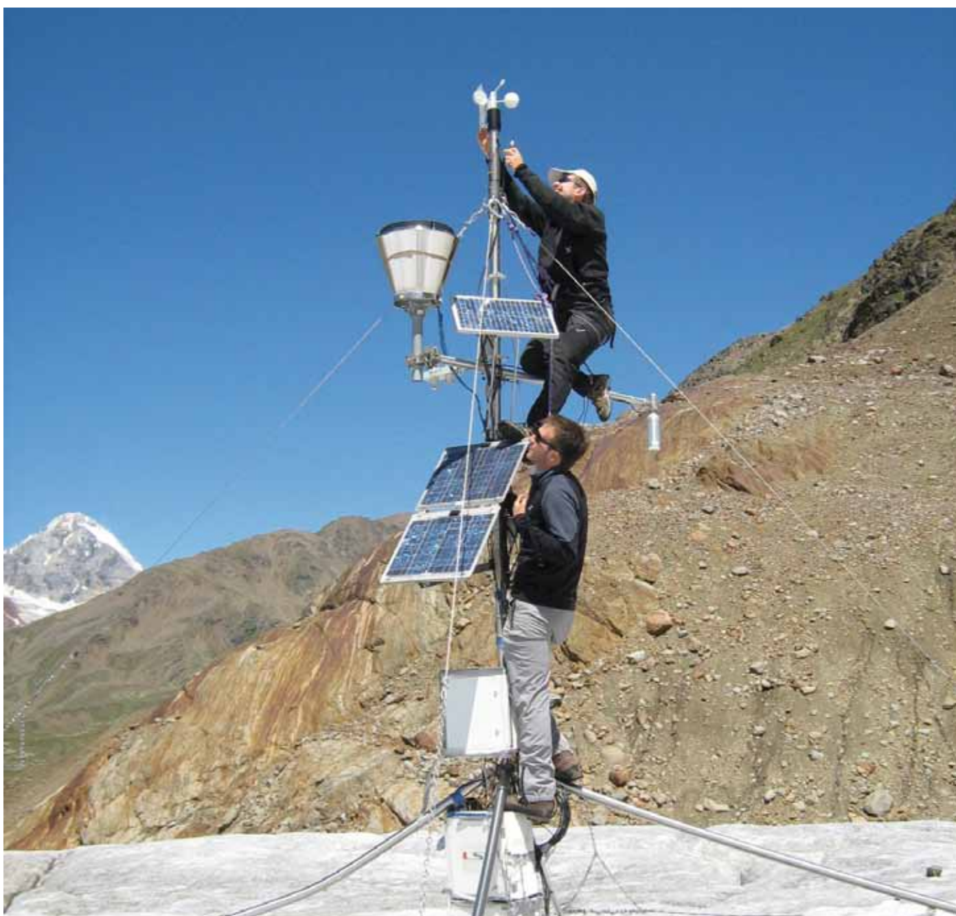
Operazioni di sostituzione dell'anemometro in cima al palo stazionario della AWS SHARE Forni (foto di R. Azzoni)
