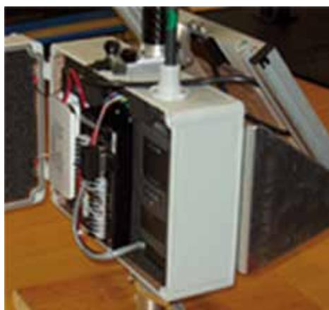
Il "cuore" del sistema portatile di misura con il piccolo pannello solare
