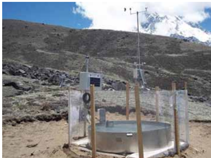
Evaporimetro installato nei pressi della Piramide per il bilancio idrologico ed energetico ad alta quota
