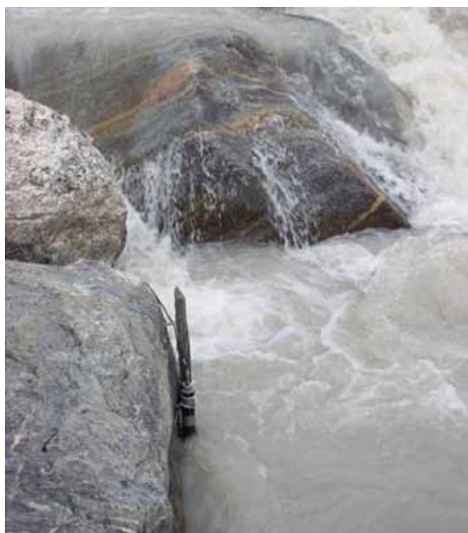
Idrometro e sonda multiparametrica per il monitoraggio idrologico e di qualità delle acque.
